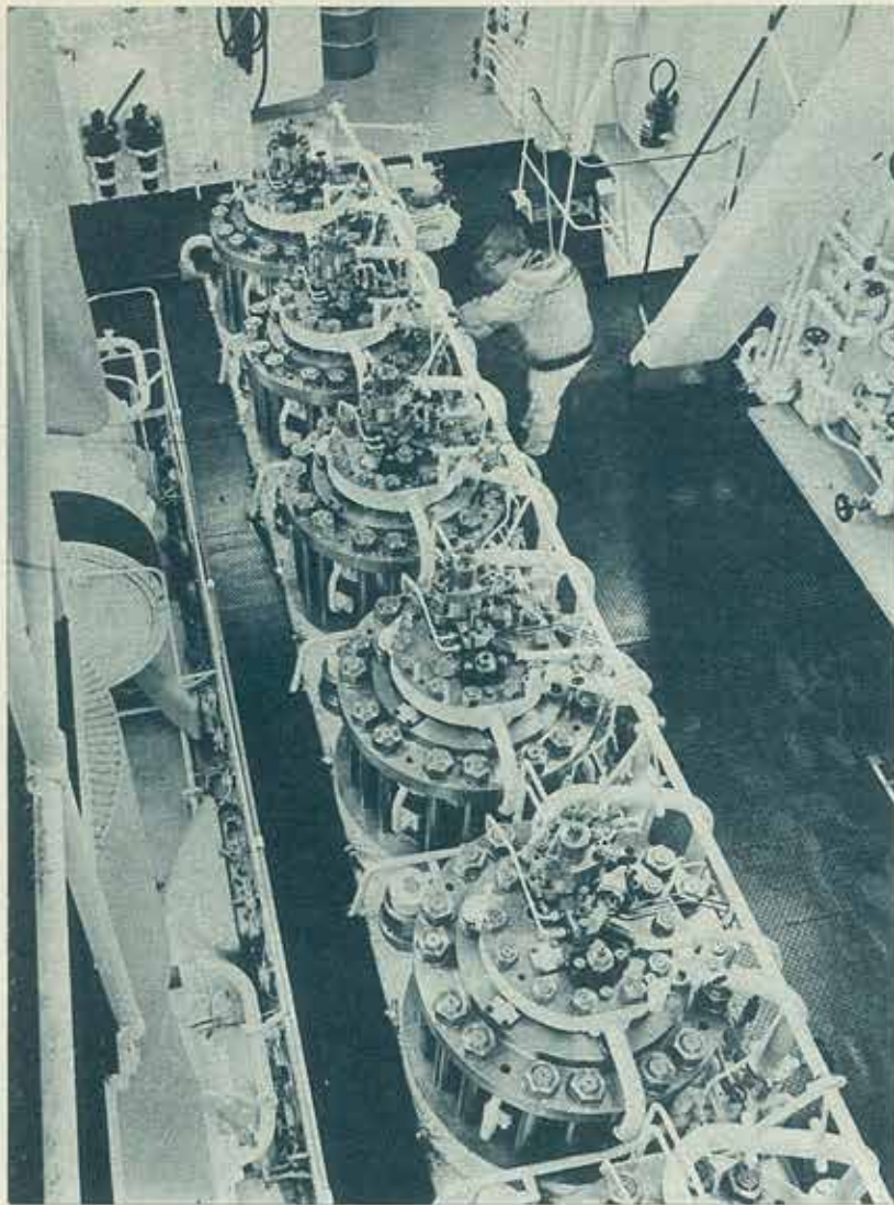
YLEISKUVA konehuoneen ylimmästä hoitotasolta. Keskellä sylinterien kannet. Vasemmalla näkyy turboahjimen imuaukkojen tumma suojaritilä.
