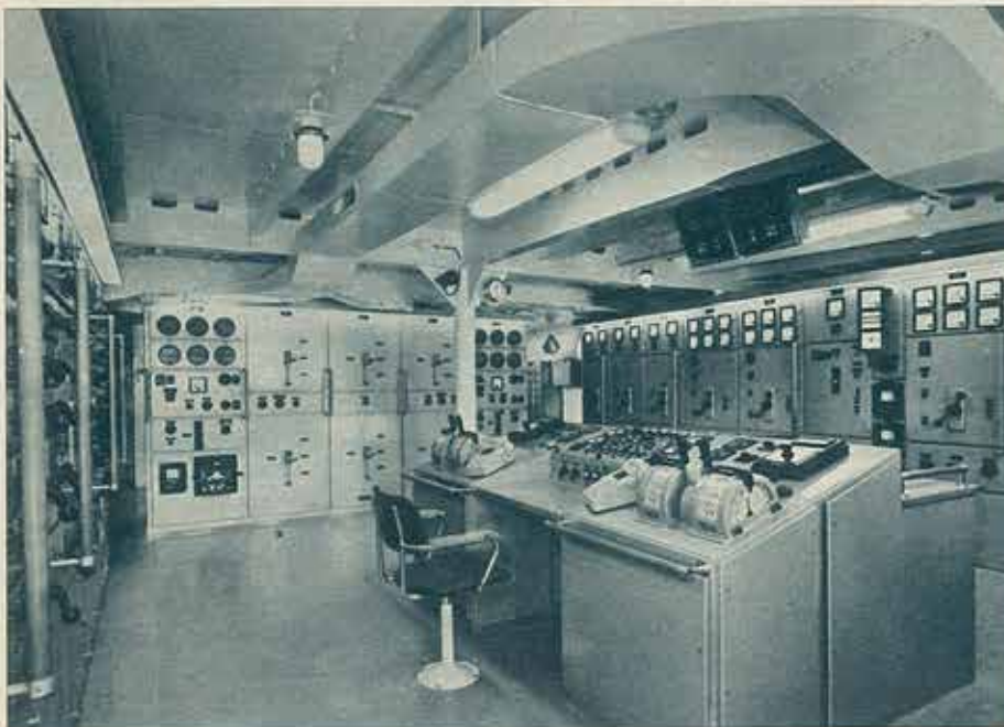
TARMOn tauluhuone, diesel-sähköisen voimansiirtojärjestelmän hermokeskus. Potkurimootoreita voidaan ohjata paitsi tauluhuoneesta myös suoraan komentosillalta ja ohjaamosta.
